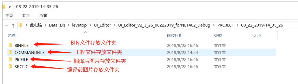
图 3: PROJECT 文件夹下级的工程文件目录
